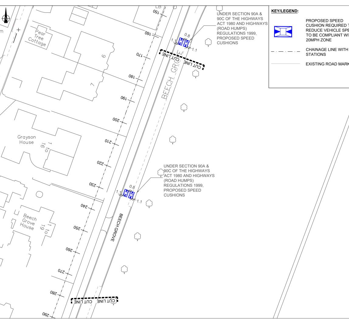
PROPOSED SPEED **CUSHION REQUIRED TO** TO BE COMPLIANT WITH 20MPH ZONE
